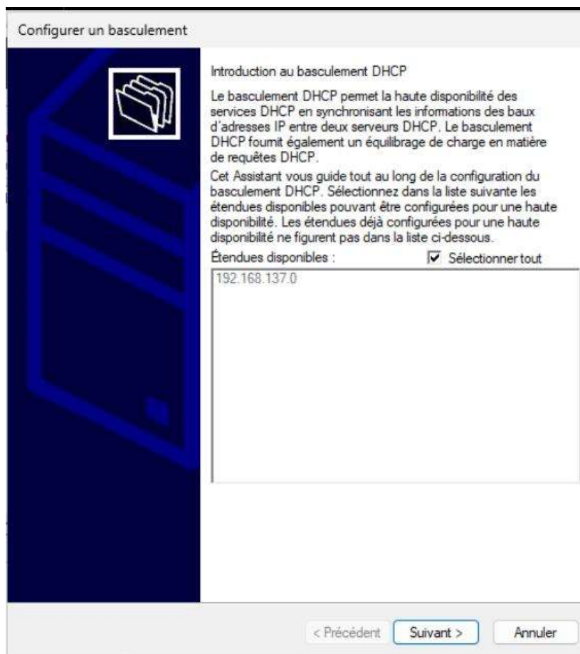
Introduction au basculement DHCP : l'étendue 192.168.137.0 est retenue
